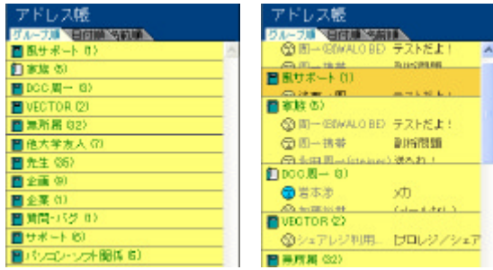
図 12: 「風」のズームングインターフェース 左) 階層が閉じられている状態 右) 階層を半分開いた状態
