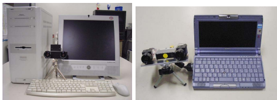
図 11: システム実装例 (左: デスクトップ PC+IEEE 高速ステレオカメラ, 右: ノート PC+NTSC カメラ)
