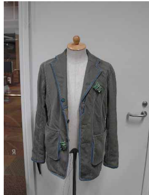
図2. 試作した導電性素材を用いた衣服
