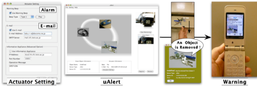
図 7: uAlert の動作概要図
