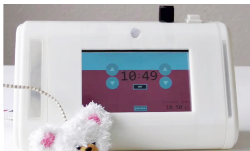
図2 MediAlarmのプロトタイプ。小型 PC(viliv S5, BRULE 社)、センサ／アクチュエータ群、および汎用I/O モジュール (Gainer mini) から構成される。これらをABS 樹脂で形成した筐体に組込んだ。
