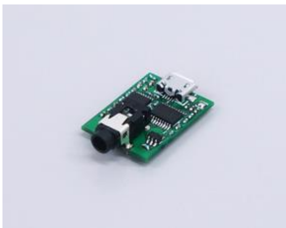
図 2 USB 接続型ハードウェア 寸法: 30mm(W) x 18mm(D) x 8mm(H)
