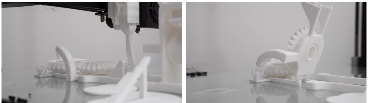
図 2. 印刷したサポート材を破壊する様子
