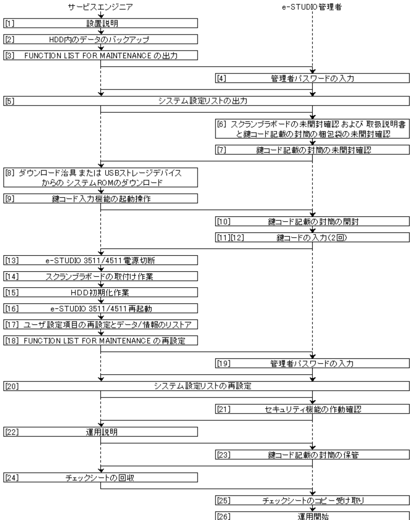
図2.6-1 スクランプラボード GP-1031導入時の作業手順
