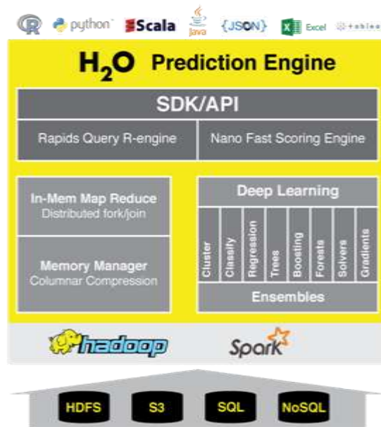
図表 15:オープンソースの機械学習プラットフォーム「H2O」のシステムアーキテクチャ
