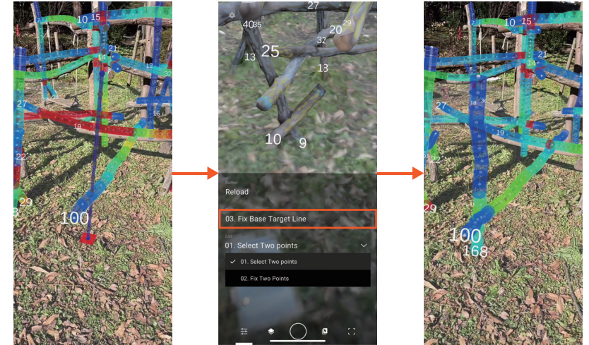
生成前 ターゲット曲線が入力され、生成 (部材の追加位置) アルゴリズム、構造解析が実行！ 生成後 (解析結果)
