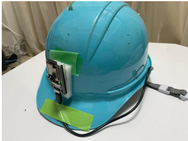
図 4 : ヘルメットに装着した撮影デバイス
