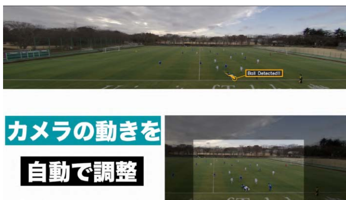
図3. カメラの動きを調整する様子：サッカーコート内の移動物体を検出し（上図）、ボールとその周囲の選手の位置に基づき画角調整（下図）
