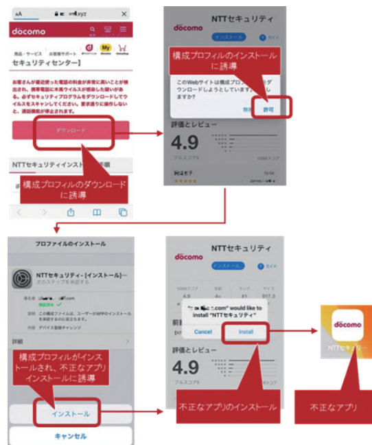
■ 図 1-2-17 構成プロファイルをダウンロードさせ、不正なアプリをインストールさせる手口
