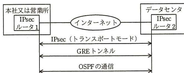
図 8 GRE over IPsec を稼働させたときの OSPF の通信の概要
