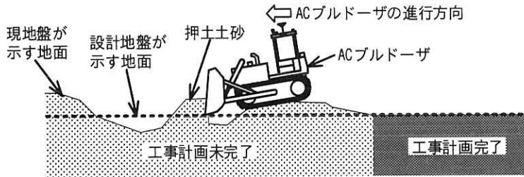
図 4 AC ブルドーザの敷均し
